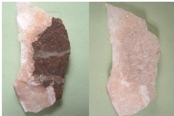
Figura 4: Frammenti di marmo di Candoglia del Duomo di Milano. Crosta nera prima (sinistra) e dopo (destra) 3 applicazioni di 15 ore ciascuna con un ceppo di batteri solforiduttori intrappolati in un sistema veicolante a temperatura ambiente. La superficie trattata è di circa 100 cm<sup>2</sup> (Cappitelli et al., 2006).
